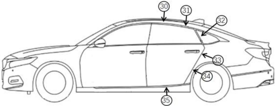
图 8 车辆左、右后门周围间隙测量位置示意图
