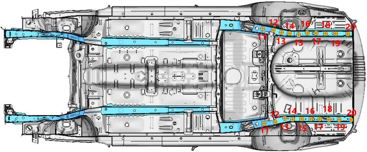
图 10 左右纵梁位移量测量区域
