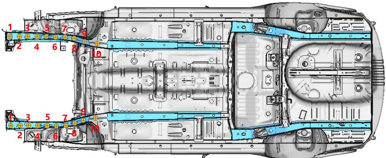
图 5 左右纵梁位移量测量区域
