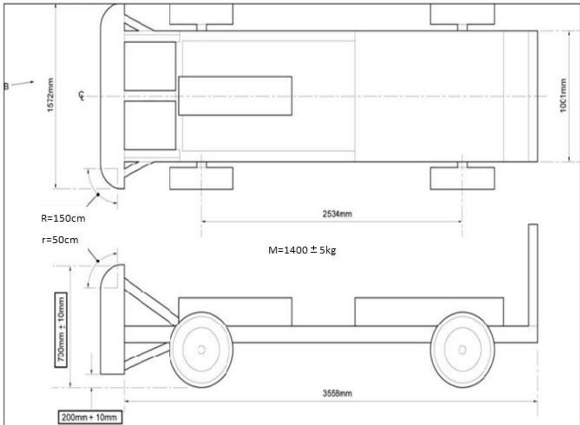
图 B. 3 移动壁障参数
