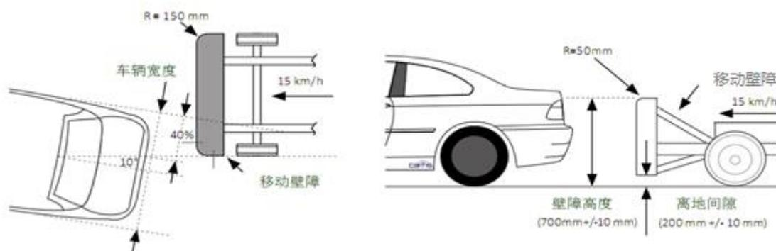
图 7 后端低速结构碰撞测试示意图
