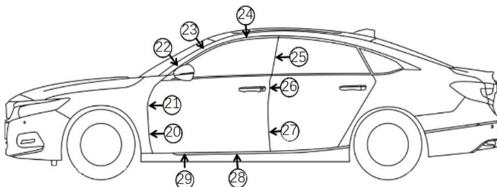
图 3 车辆左、右前门周围间隙测量位置示意图
