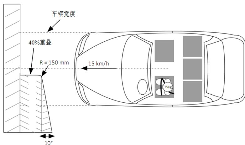
图 2 前端低速结构碰撞测试示意图
