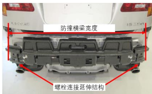
图 C.3 螺栓连接延伸结构的测量
