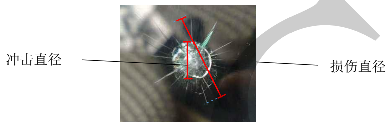
图 5 冲击直径与损伤直径
