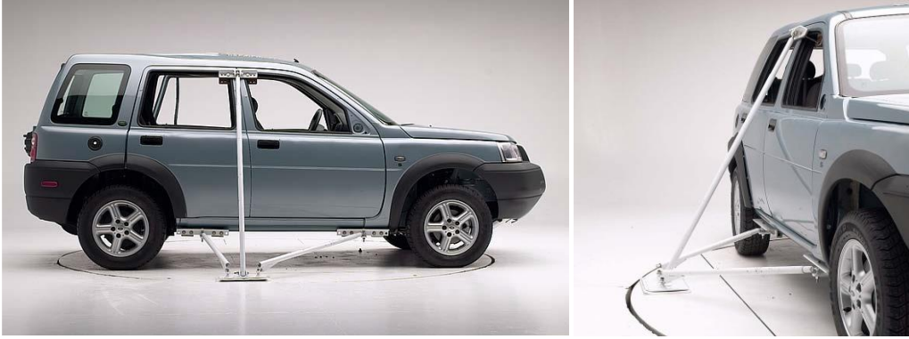
图 2 SUV、皮卡车以及小客车所需的防侧翻装置
