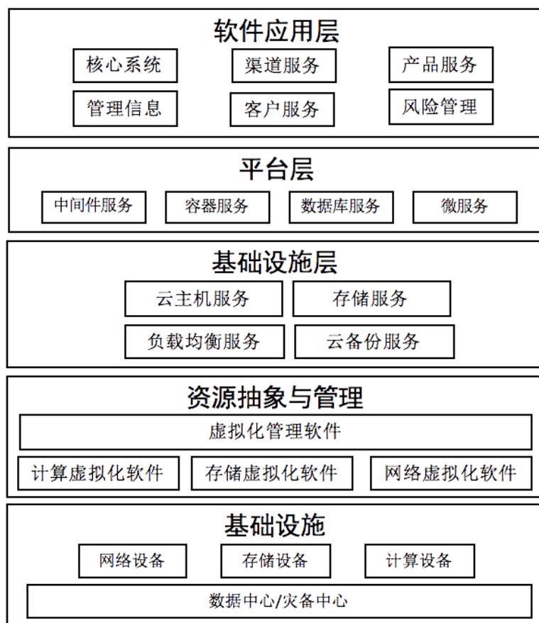
图 1 云计算架构图
