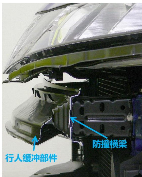
图 B.1 行人缓冲防护结构与防撞横梁一体结构（剖视图）
